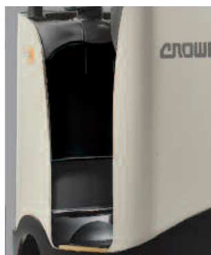
Wycielanie ścianek przedziału operatora
