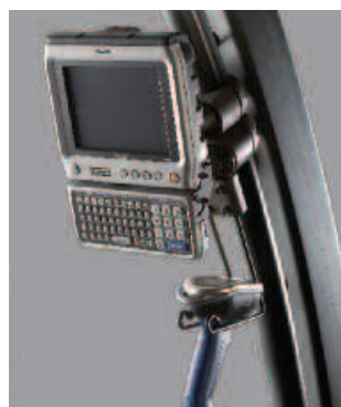
Gama akcesoriów Work Assist™ obejmuje uchwyty mocujące do terminali WMS, podkładkę do pisania, hak, kieszeń na drobiazgi i oświetlenie sufitowe.
